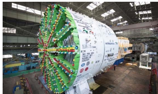
写真-1：シールドマシン
