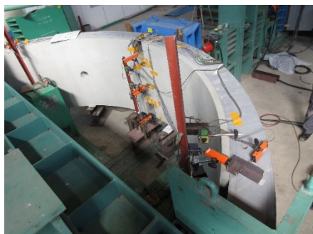
写真. 6-1 継手曲げ試験 試験状況
