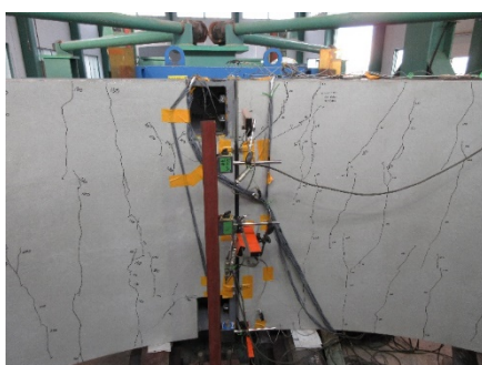
写真. 6-2 継手曲げ試験 試験体
