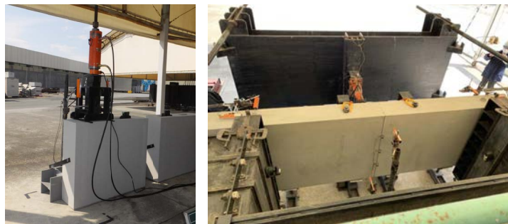
写真-5 引抜き試験状況
