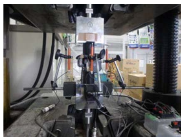
写真-3 単体引張試験状況
