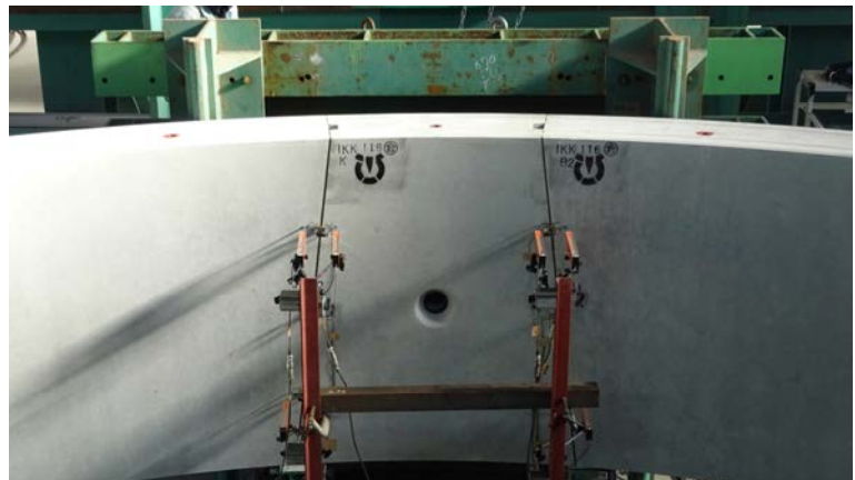
写真-1 継手曲げ試験状況
