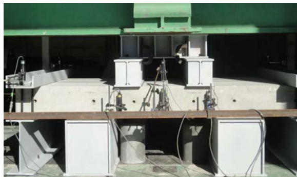
写真-2 リング継手せん断試験状況
