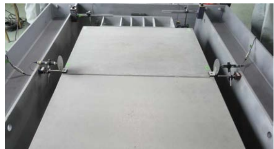
写真-1 リング継手引張試験状況
