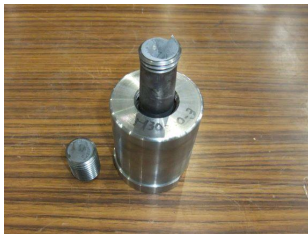
写真4 引張試験後の試験体の状況 (M30)
