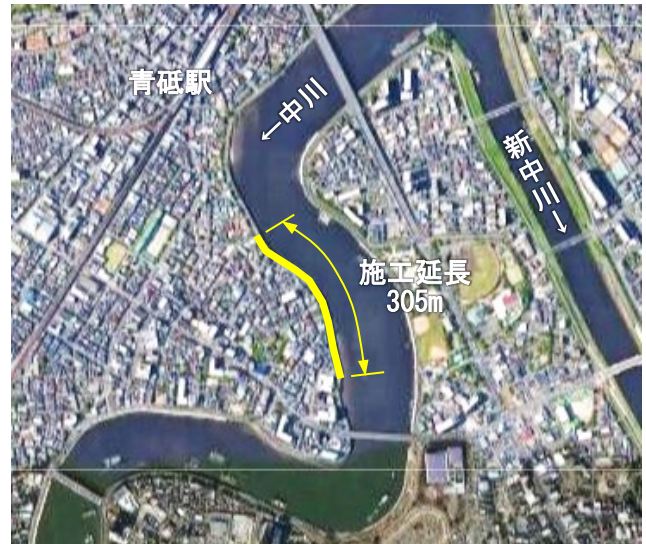
図-1 中川護岸耐震補強工事の全体図
