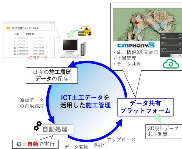
図-4 ICT 土工管理システムの概要
