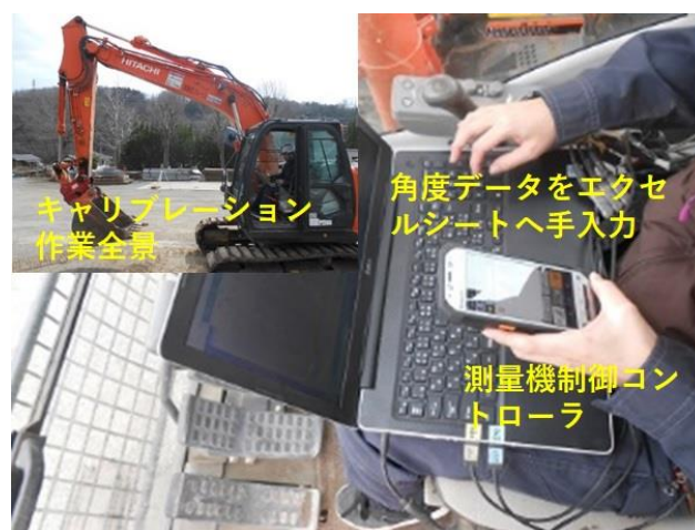
図4 キャリブレーション作業中
