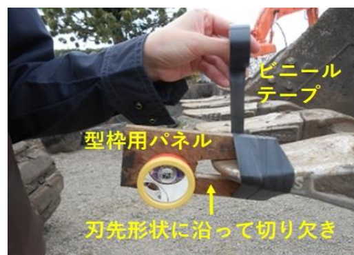
図5 バケット取付用治具
