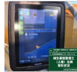
写真-4 ICT 建機操作パネル
