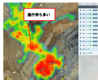
図-2 階段増設前
