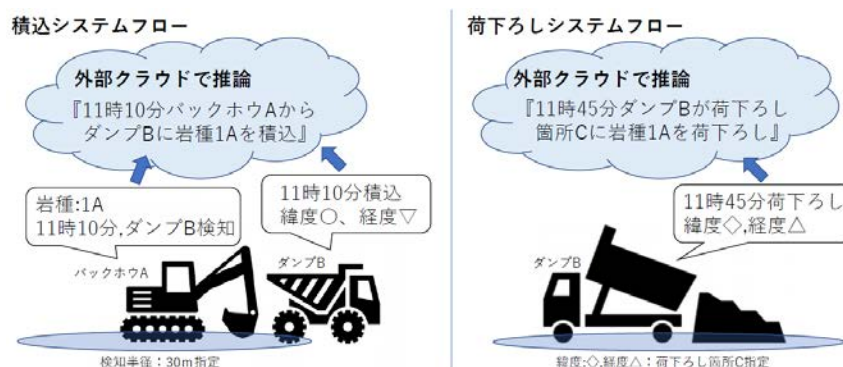
図-4 土工支援システムフロー（積込・荷下ろし）
