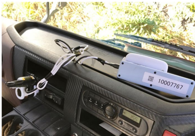
写真-3 運搬車両内のIoT機器（GPS）搭載状況
