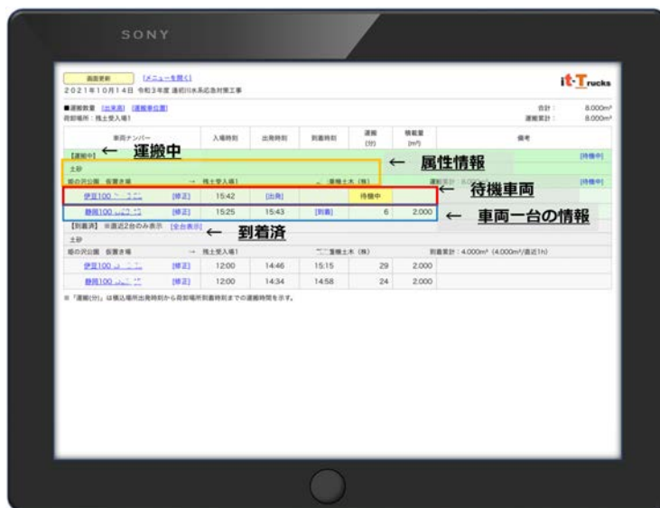
図-3 it-Trucksの運搬状況確認画面
