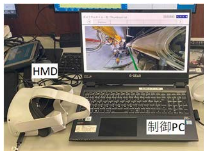
図7 制御PC及びHMD設置状況
