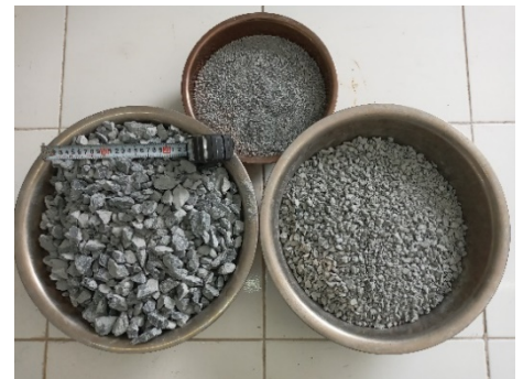
写真-1 製造骨材
