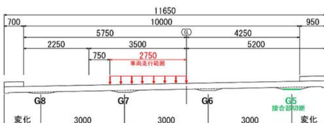
図8 車両走行範囲と、ずれ止めを切断する主桁
