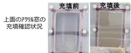
図-5 モックアップ充填実験の充填状況
