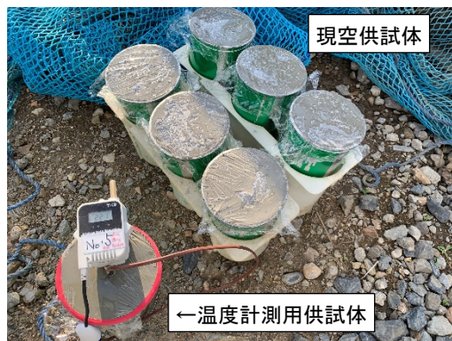
(1) 現空供試体採取と温度計測用供試体
