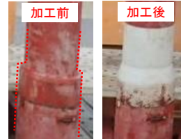
写真-2 トレミー管 テーパ加工
