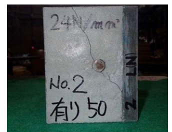
写真-4 鉄筋引抜試験状況
