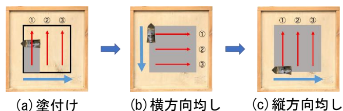
図3 塗付けおよび均しの流れ
