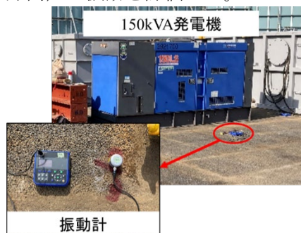
図-3 発電機と振動計
