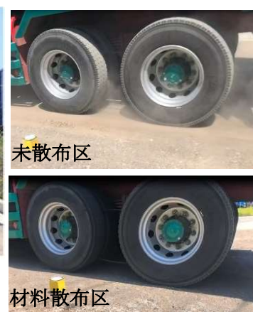
写真-4 ダンプ走行中の粉じん飛散状況
