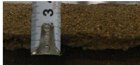
写真-1 土壌被膜厚測定
