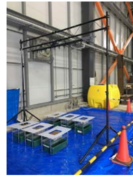
写真-2 耐雨試験の状況 コンテナ設置
