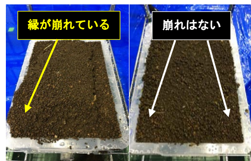
写真-4 耐雨試験後の状況 (左)未散布 (右)開発品 T-2
