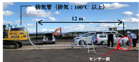
図-1 バックホーCO 2 排出量測定状況
