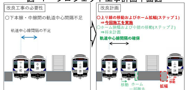
図-2 プロジェクト工事計画断面図
