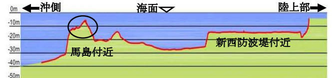
図3 ケーブル敷設ルートの縦断面図
