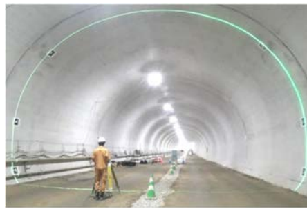
図 3 (左) 計測状況 (右) TS と AR マーカーを用いたスケール調整
