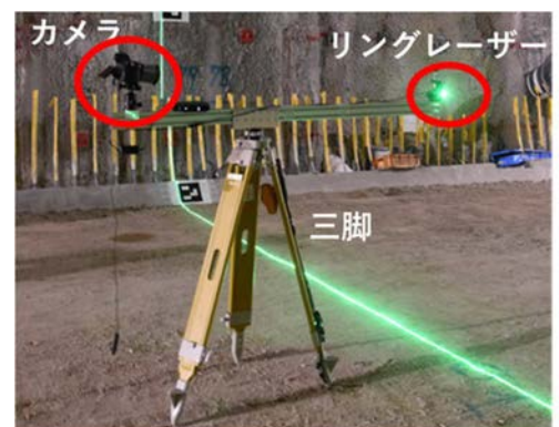
図2 光切断法による計測装置の概要
