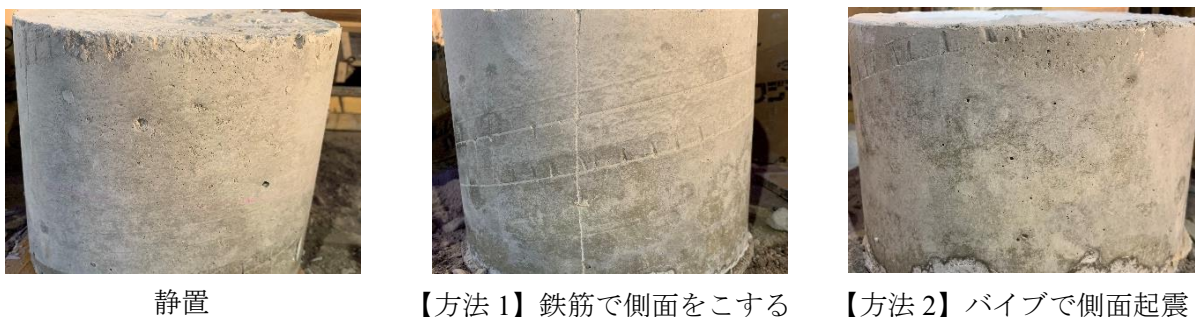
図-2 型枠に付着した気泡の除去方法効果確認試験結果
