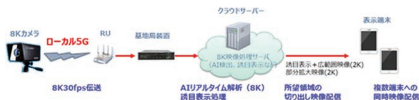
図 2 超高精細映像監視システムの構成
