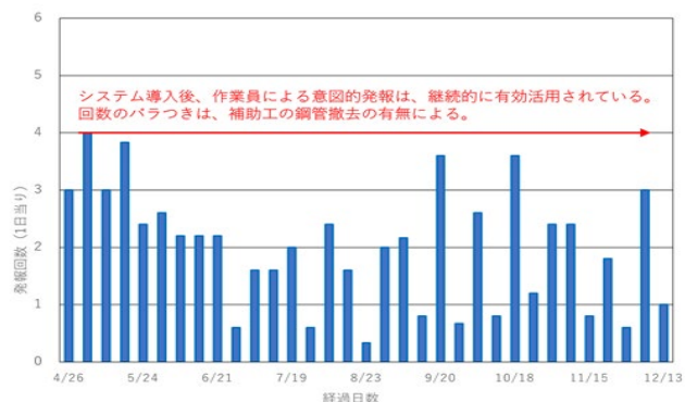
図5. 作業員による意図的発報回数
