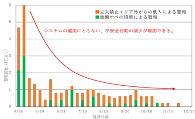
図4. 切羽作業エリアへの立入の警報回数
