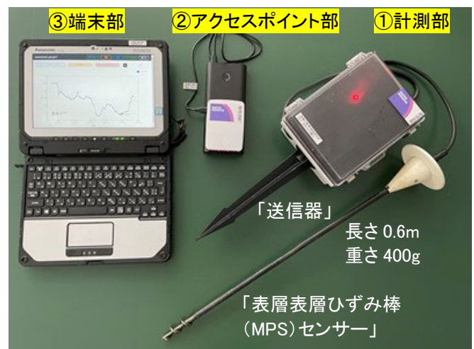
図-1 土砂崩壊モニタリングシステム
