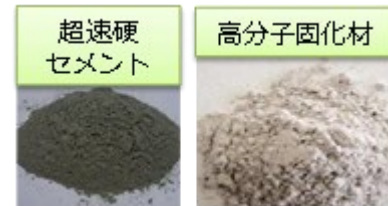
図2 低強度安定処理工法の補修材
