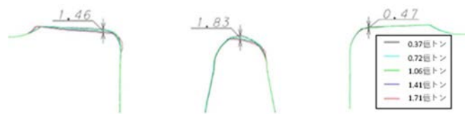
図-7 新圧接Crの断面形状(ノーズ幅20mm)
