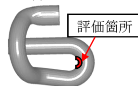
(b) ひずみ評価箇所 繰り返し着脱試験状況
