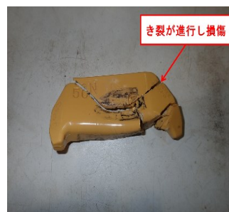
図 6 損傷したインシュレータ
