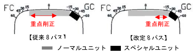
図 2 砥石角度の変更による削正断面
