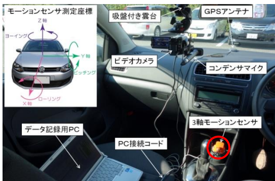
図-1 測定車両とセンサ(赤丸)設置状況
