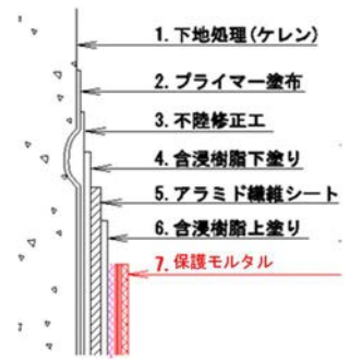
図3 補強工法断面図
