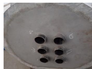
圧縮用供試体外面の例
