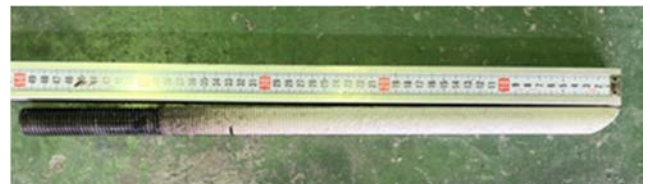
写真-5 抜き取りしたボルト (M24)
