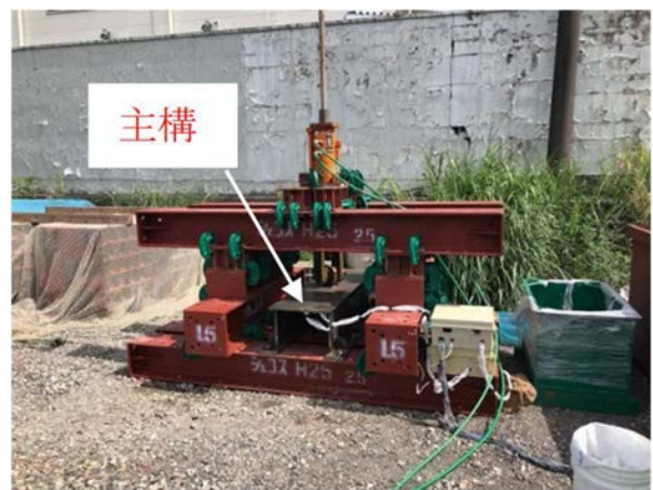
写真-1 スラブアンカー引き剥がし模擬実験
