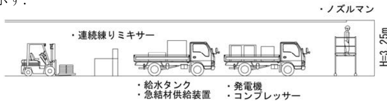
図-3 施工機械配置図
