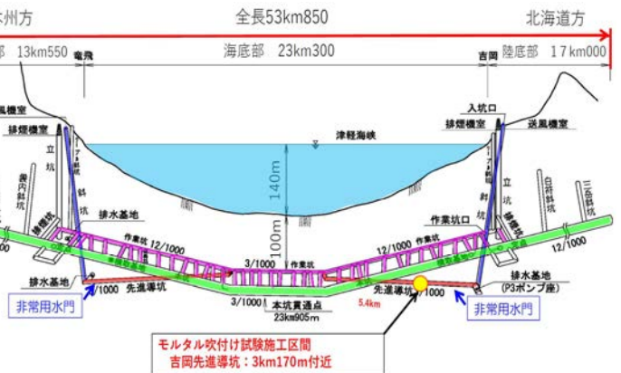
図-1 青函トンネル概要と試験箇所
