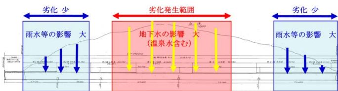
図-4 土被りと劣化発生箇所の関係
