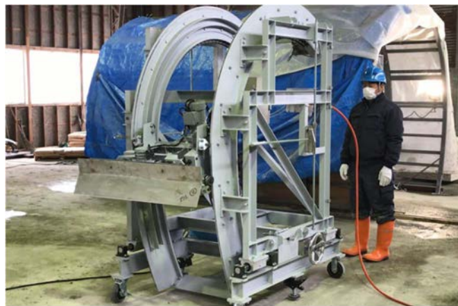
写真-3 導水路トンネル自動均し機
