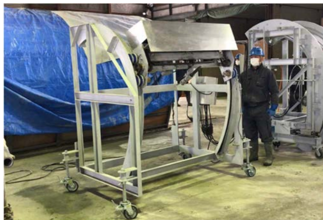
写真-2 導水路トンネル自動吹付け機
