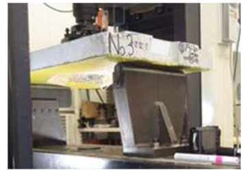
写真-4 押し抜き試験の状況
