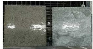
写真-5 プライマー塗布後の白濁やムラの状況 左が正常 右が高含水率下での施工
