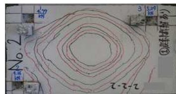
写真-6 押し抜き試験後の状況 赤黒のマーキングがはく離周長
