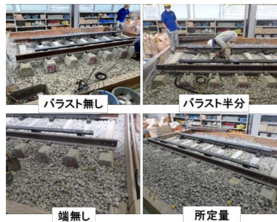
図-5 道床バラストの状態
