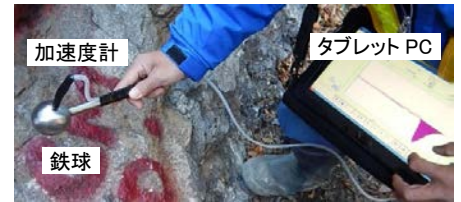
図-1 打球探査法実施状況
