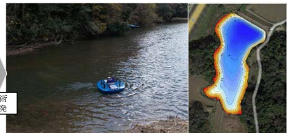
図5. 水面ドローン及びマッピング結果
