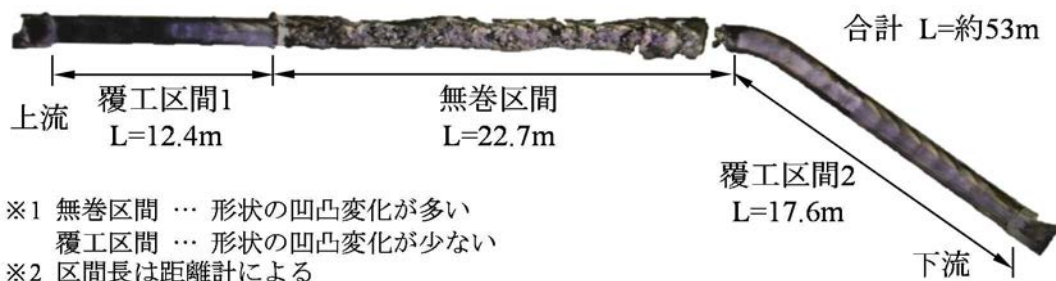
図 2 平面図 (見上げ図, 投影写真入り)
